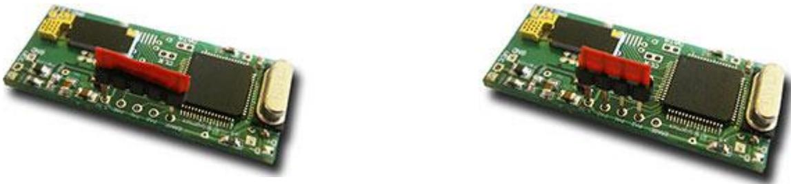
*Limpieza de memoria (ERASE conectado a 3.3V)    Activación del bootloader (PA0, PA1, PA2 y TST conectados a 3.3V)*
