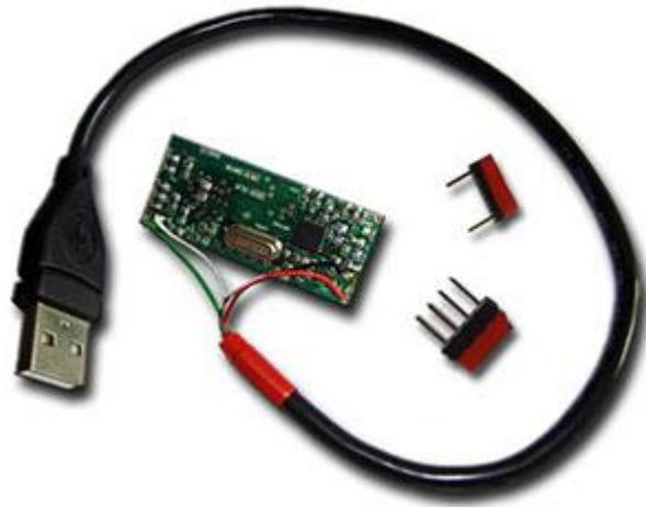
*El cable USB y las armaduras para bootloader SAM-BA*
