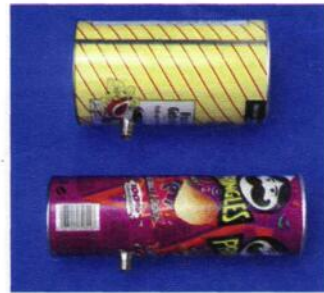
Die selbstgebaute Pringles-Antenne schlug sich in der Messung zwar besser als ein loses Kabelende, aber deutlich schlechter als die Kaffeedose.
