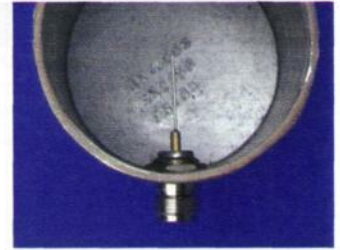
Das Innenleben der Dosenantennen ist denkbar einfach: Für 2,4-GHz-WLAN genügt ein 31 m langer /4-Strahler aus versilbertem Kupferdraht.
