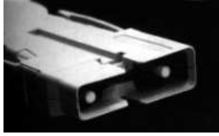
FIG. C.9 – Connecteur FDDI ou MIC
