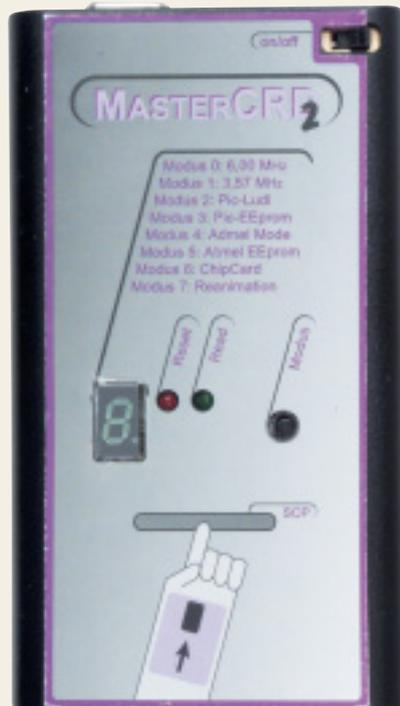
Ein einfaches serielles Kabel verbindet den Master CRD 2 mit dem PC oder Notebook. Die Datentransfertrate der COM-Ports ist für die geringe Datenmenge der Smartcards völlig ausreichend.
