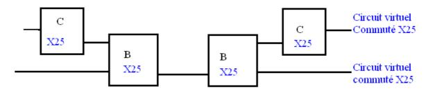
Dans le RNIS, on a le 2B + D: numérique de bout en bout. Le canal D fonctionne en mode paquet (X25).
