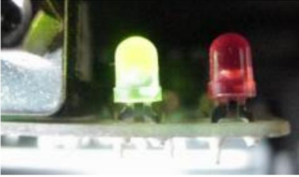
Jedes bessere Season-Interface hat zwei Signal-Leds: Die grüne signalisiert in der Regel, daß die Stromversorgung paßt, die rote blinkt wenn der Decoder mit dem Interface kommuniziert.
