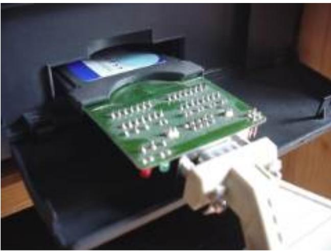
Anstatt einer Pay-TV-Karte wird im Decoder-Kartenschlitz eine Platine eingesteckt, die per seriellen Kabel zum PC führt.
