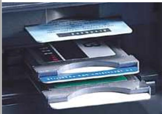
"CI", Universelle Einschübe eines digitalen Empfängers für CA-Module: Ein Empfänger mit "Common Interface", kann also für alle erdenlichen Pay-TV-Entschlüsselungen genutzt werden, in dem die passenden CA-Module eingesetzt werden.
