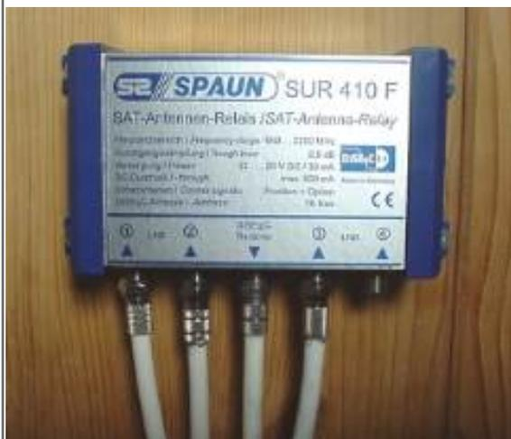
"Digital Satellite Equipment Control" - mit diesen Schaltsignalen kann ein Sat-Empfänger zwischen verschiedenen angeschlossenen LNBs umschalten.
