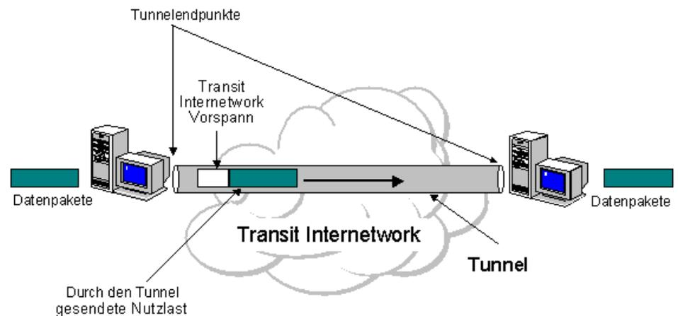
Abbildung 5: Tunnelverfahren (Tunneling)
