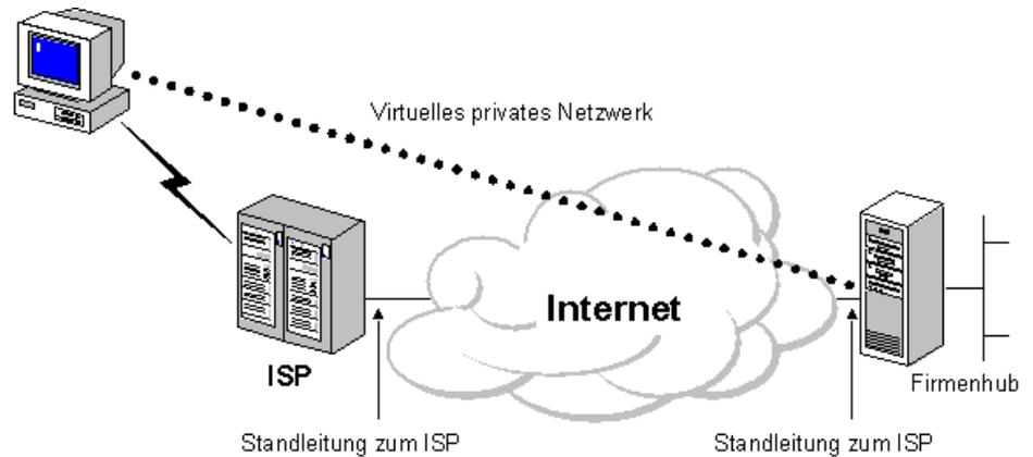
Abbildung 2: Verbinden eines Remoteclients mit einem privaten LAN unter Verwendung eines VPNs
